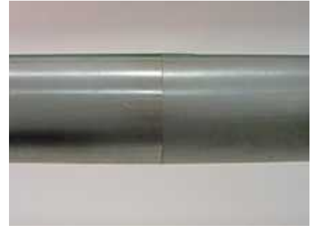
Hauptspannen Beide Rohre richten sich aus
