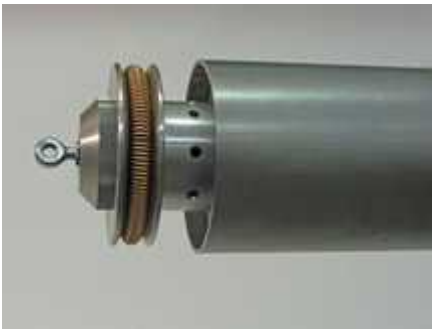
Vorspannen das Spanngerät richtet sich aus
