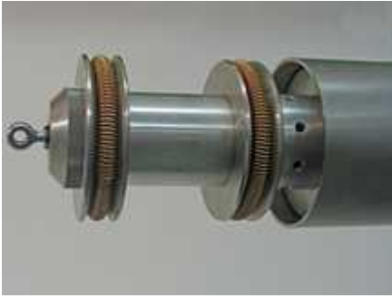
Vorspannen das Spanngerät richtet sich aus
