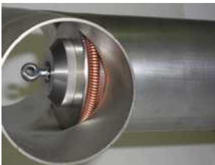
Hauptspannen das Formteil richtet sich aus
